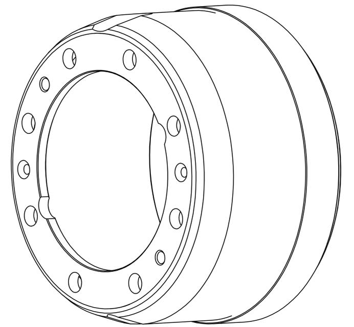
1. Форма графита: ПГф1, ПГф2. Распределение графита: ПГр1, ПГр2, допускается ПГр7. Размер графитовых включений на рабочей поверхности Ж на глубине до 5мм не более 180 мкм в остальных сечениях не более 350мкм.
