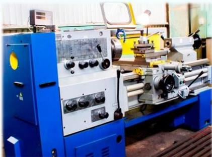
Максимальный диаметр обработки: 168 мм (над станиной 330 мм), максимальный диаметр прутка: 52 мм, максимальная длина обработки: 1000 мм, скорость вращения шпинделя: до 2500 об/мин.
