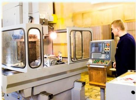
Максимальное перемещение X/Y/Z: 1000 мм/630 мм/550 мм, размер неподвижного стола: 1120x630 мм, скорость вращения шпинделя: от 20 до 2000 об/мин, максимальный растачиваемый диаметр: 250 мм, разрешающая способность по координатам: 0,001 мм, наличие системы ЧПУ.
