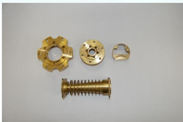
Пример фрезерной обработки деталей
