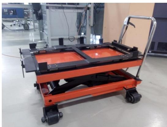
Приспособление для перемещения изделия в трех плоскостях испытательной камеры
