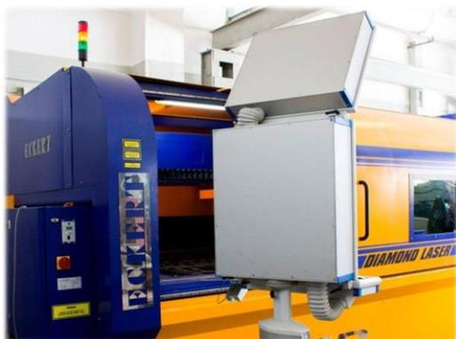
Оборудование позволяет вырезать детали из листового проката. Материалы: стали (в т.ч. нержавеющие) и цветные металлы (алюминий, латунь, медь и др.), максимальные размеры заготовки: 1500x3000 мм, максимальная толщина: до 10 мм. Точность изготовления по 14 качеству.
