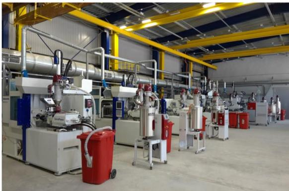
Также участок оснащен термопластавтоматами для литья силиконов и двухкомпонентного литья. Двухкомпонентные ТПА позволяют изготавливать детали различных цветов, а также детали, состоящие из двух различных материалов.
