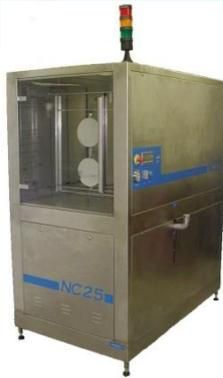
**Отмывка печатных узлов** после монтажа осуществляется на установке, позволяющей комбинировать различные методы агитирующего воздействия для достижения наилучшего качества отмывки (мех. колебания, барботаж, ультразвук, струя). Контроль качества отмывки печатных узлов осуществляется на установке контроля ионных загрязнений GEN3.
