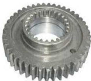
Процесс зуборезных работ проходит в соответствии с ГОСТом, детали могут изготавливаться по фрагментам изделий или по чертежам заказчика. Большая часть зуборезных работ проходит на специальных станках с числовым программным управлением.
